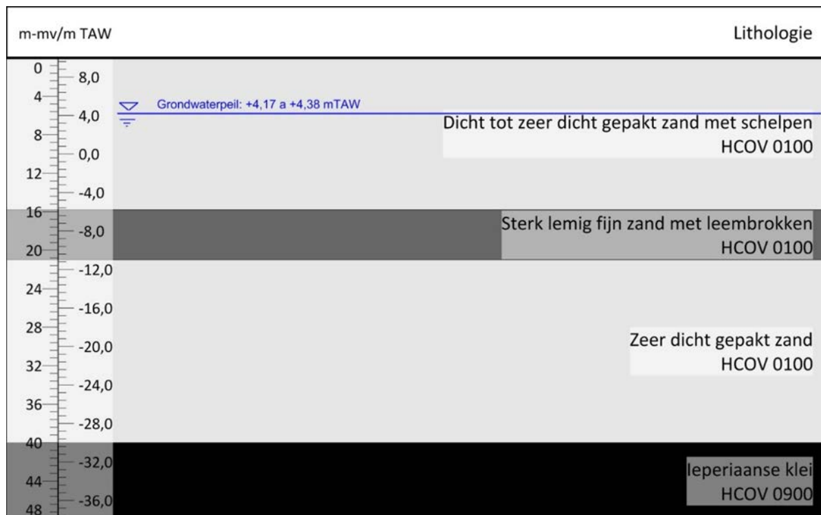
Figuur 73 lokaal hydrogeologisch profiel
