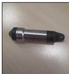
Figuur 7 waterpeilmeetlint en dataloggers voor het opmeten van de grondwaterstand
