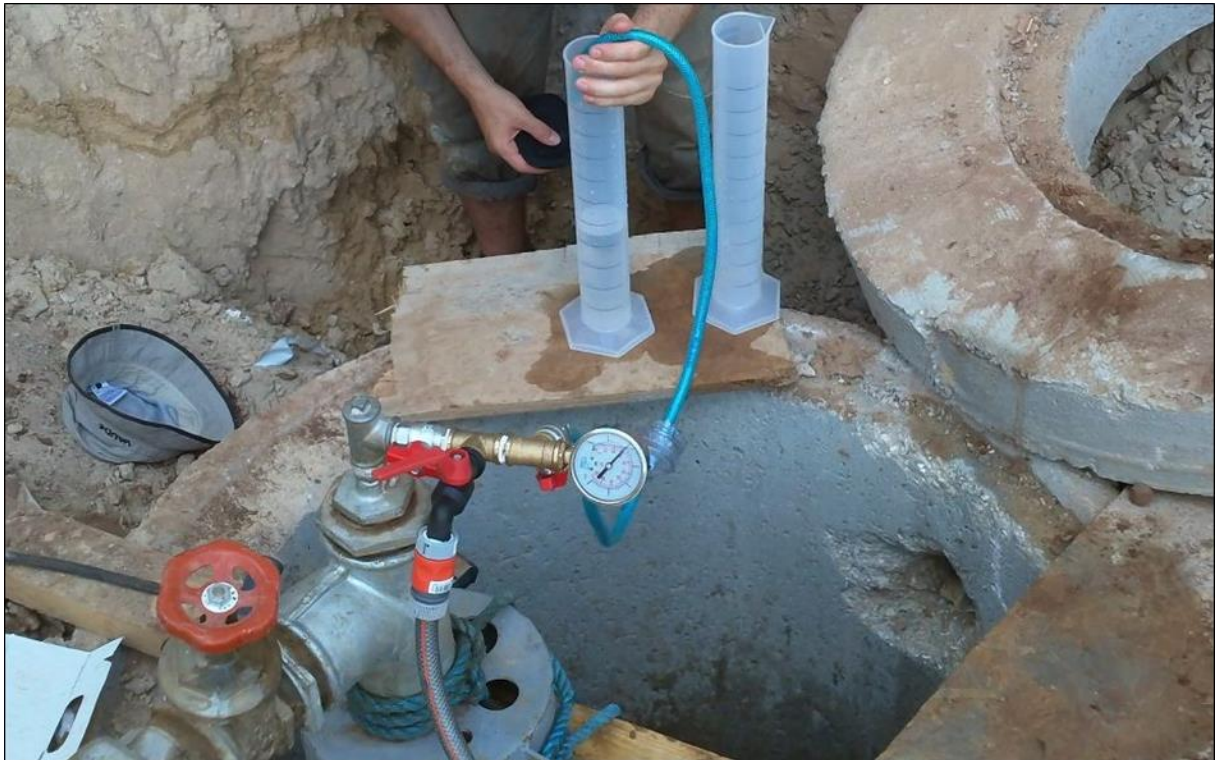
Figuur 40: illustratie van een MFI-test op het terrein
