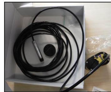
Figuur 7 waterpeilmeetlint en dataloggers voor het opmeten van de grondwaterstand
